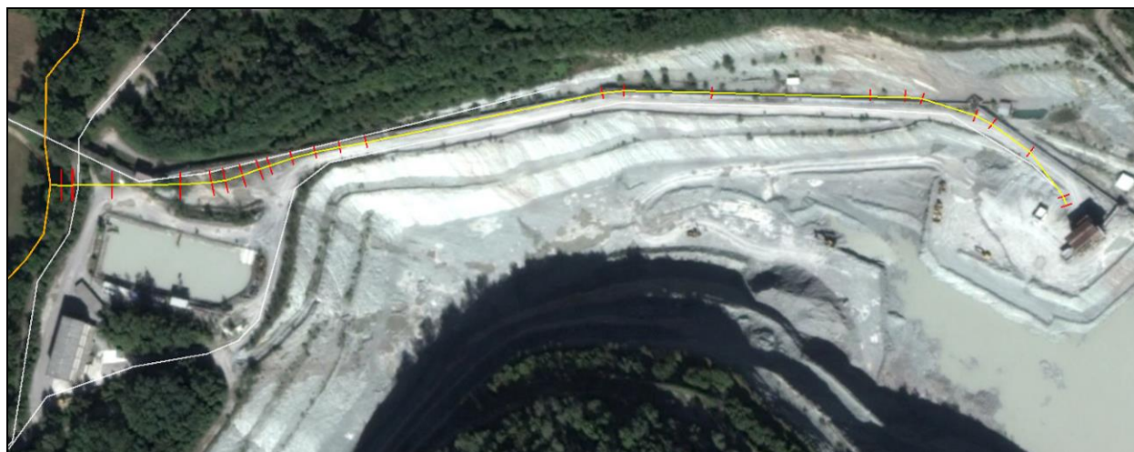
Figura 13 – Traccia delle sezioni idrauliche utilizzate per la predisposizione del modello numerico idraulico del canale scolmatore che sarà realizzato lungo la pista di accesso al fondo cava già esistente
